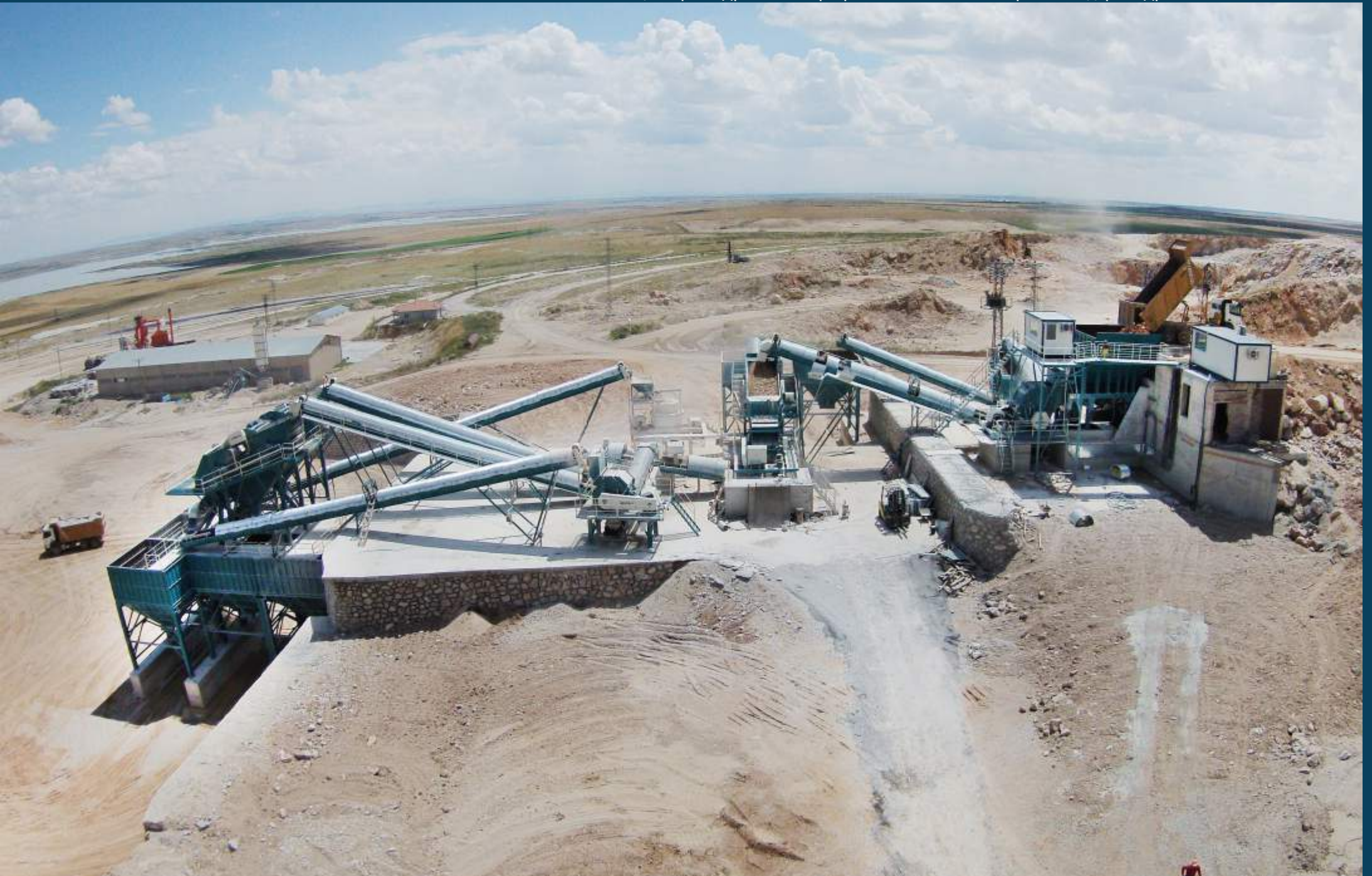
Stationary crushing and screening plant with primary impact crusher (400-500 t/h) Стационарный Дробилно-Сортировочной комплекс с Первичной Ударной Дробилкой (400-500Тонн/Час)
